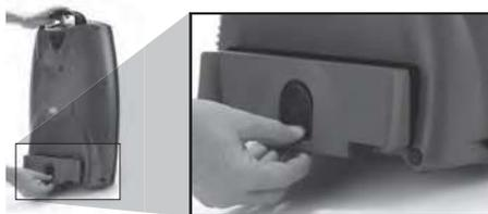
Pour retirer la batterie, abaissez le levier de déverrouillage noir. Tout en maintenant le levier de déverrouillage ABAISSÉ, tirez sur la batterie pour l'extraire du système Eclipse 5.
